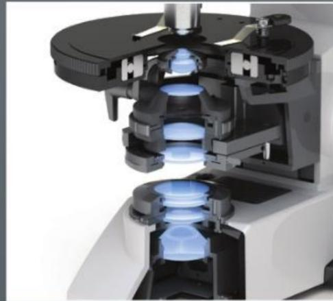
精確的錐體成像，在視鏡頭與待測物之間提供可聚焦 Bertrand 透鏡的集成模組。Bertrand 透鏡的中心定位能夠通過中心螺絲來定位。在分析儀模組上內建插槽，方便存放六角扳手，便於對準分析儀和目鏡。
