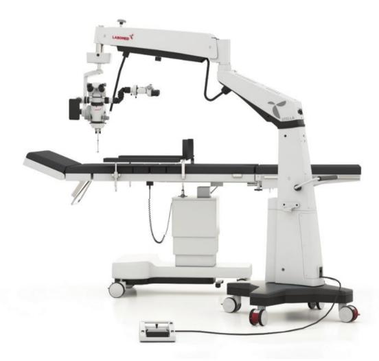
Stella 提供眼科醫師一個防水腳踏控制(10 種方式),其可毫不費力地驅動 X、Y 與 Z 軸的馬達,同時具有磁力變化和光源強度控制功能。鏡臂系統上安置了紅外線(IR)與紫外線(UV)安全的 LED(5700 kelvin),其將提供穩定、清晰的白色照明,使操作更加舒適、準確和安全。
